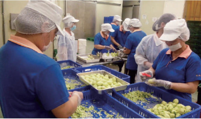
土芒果的大小不一，無法進入機械生產線，需以人工作業，手工切削。
