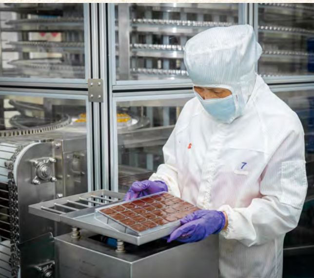
(左) 注模後的巧克力需要經過機器「震平」，表面才會變得光滑。 (右) 完成冷卻的巧克力脫模後，就可以進入包裝流程，準備出貨！
