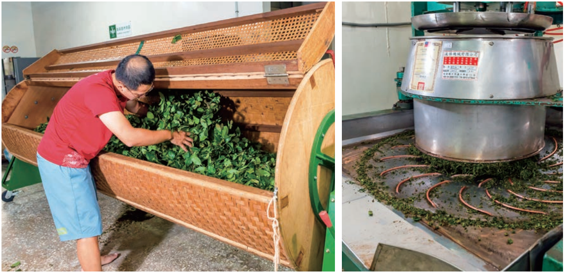
(左) 製茶需經過萎凋、浪菁、發酵、炒菁、揉捻等過程，非常依賴經驗和勞力。 (右) 揉捻是製茶的重要工序，藉此讓茶葉的細胞組織被擠壓並釋放茶汁。
